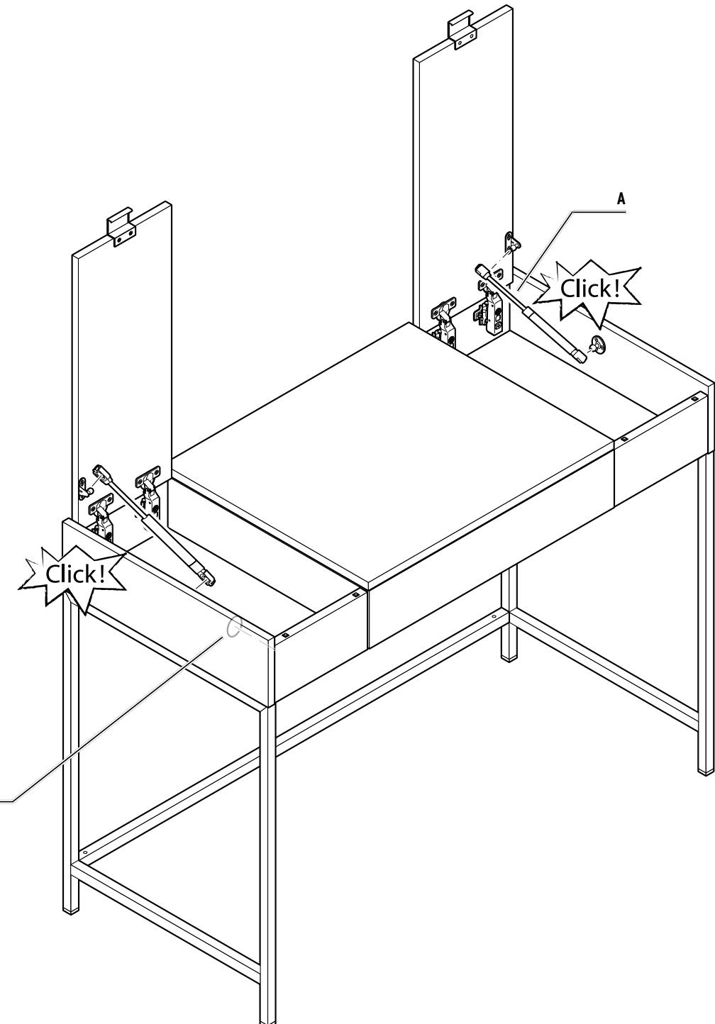
**Klappenhalter lösen | Détacher le ressort pneumatique | Distaccare la cerniera del coperchio**
